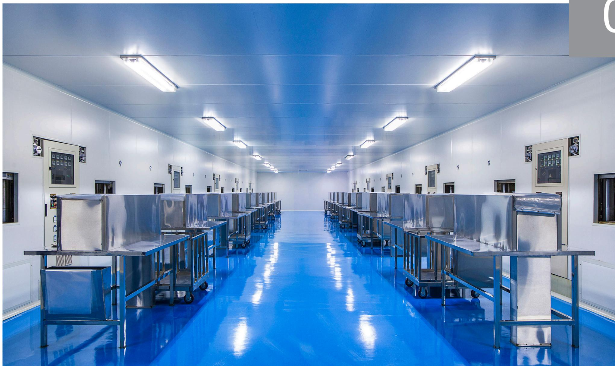
层高较低的厂房是指顶棚高度在5m以下的厂房,此类厂房涉及范围很广,视觉作业的内容大部分是工作对象体积小的精密视觉作业,在光源和照明方式的选择上,应结合生产车间的实际情况进行选择。对于生产精密仪器、电子配件、电子零件组装或印刷排版校正等一类的生产车间,其设计照度应相应提高;对于纺织厂、服装厂、印染厂、食品加工厂等一类的生产车间,在灯具选择上应选用高显色指数的灯具。在照度要求较高的厂房中,建议采用混合照明的方式,可选用大面积发光的灯盘做主光源,并结合自然光进行补光;对于精细作业的空间,采用高亮度,高显色的灯具,在满足基本照明的情况下,可高度还原原有色彩细节,让生产更加精细。
